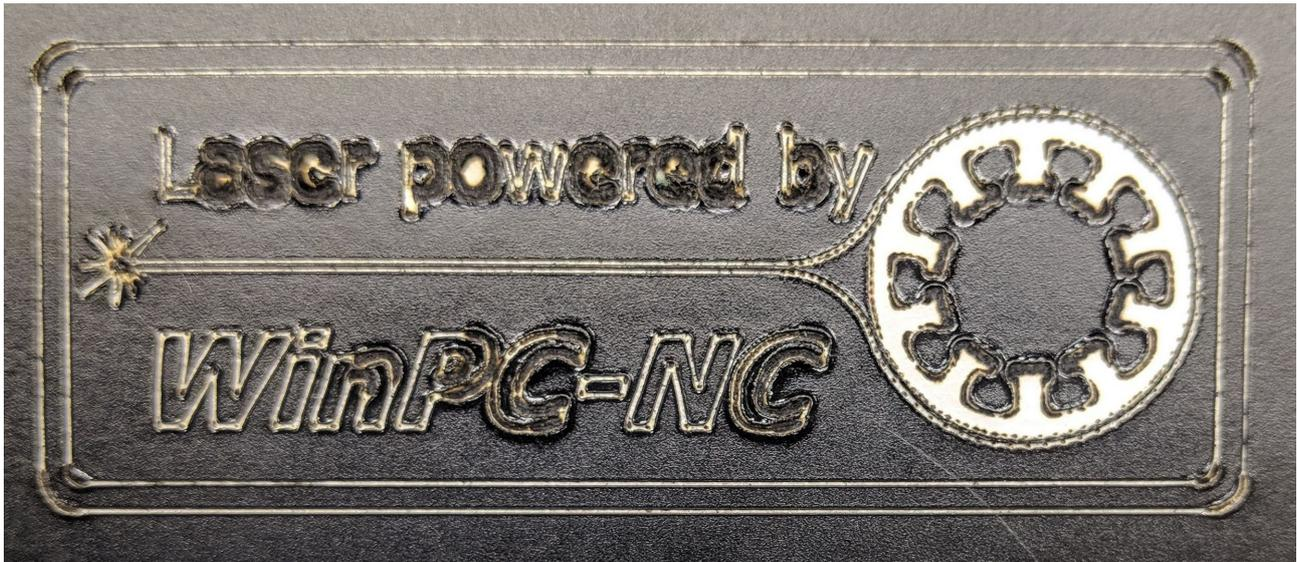
Folienschnitt mit Laser **OHNE** Leistungsreduzierung in Ecken und Radien.
